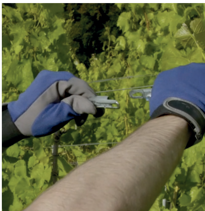
Dwuczęściowa konstrukcja umożliwia stworzenie bezpiecznych punktów zaczeplenia po obu stronach zerwanego drutu; elementy te są następnie ze sobą łączone, a mechanizm zatraskowy zapewnia szybkie i proste połączenie.
