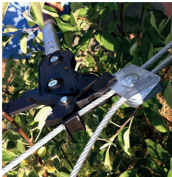
Dynamic 6 – Napinanie z użyciem szczypiec
